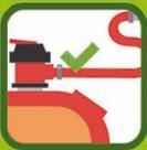
En las instalaciones de butano/propano, vigile el buen estado del regulador y del tubo flexible, así como su caducidad.
