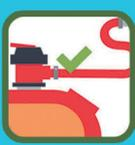
En las instalaciones de butano/propano, vigile el buen estado del regulador y del tubo flexible, así como su caducidad.
