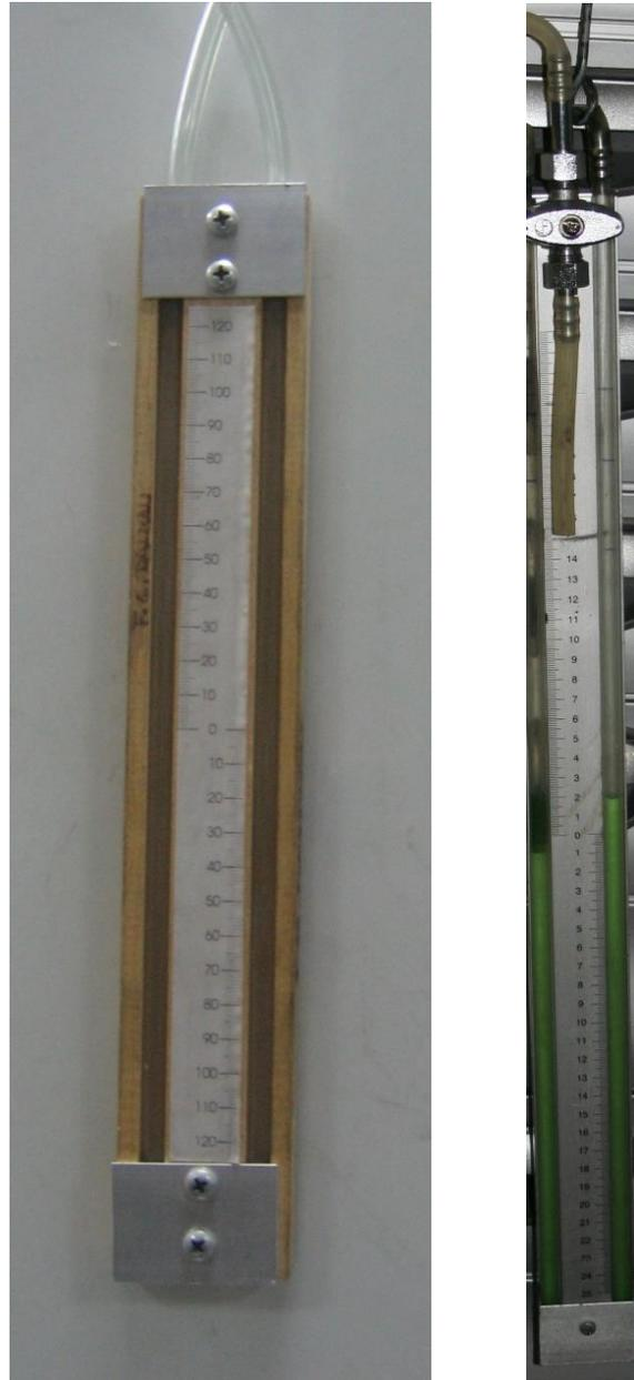
**Manómetro de prueba en instalación hasta 240 y 500 mmcda respectivamente.**
