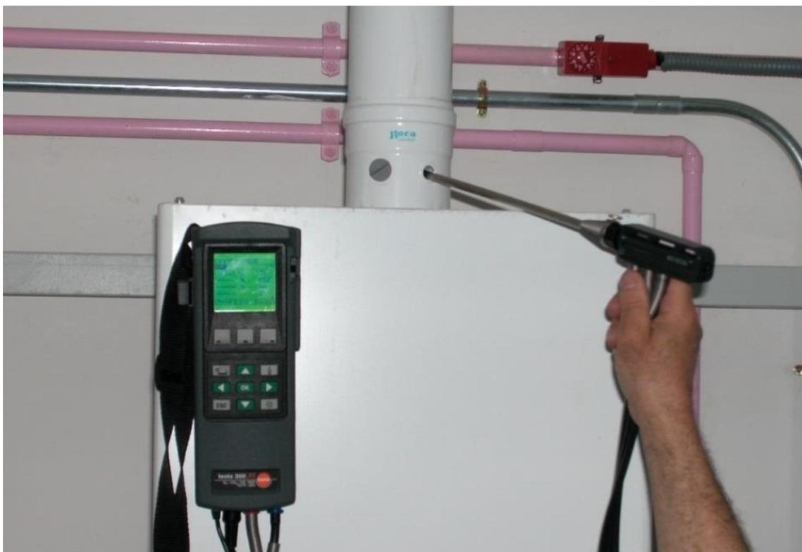
**Figura 11 Medición de CO en PdC**
